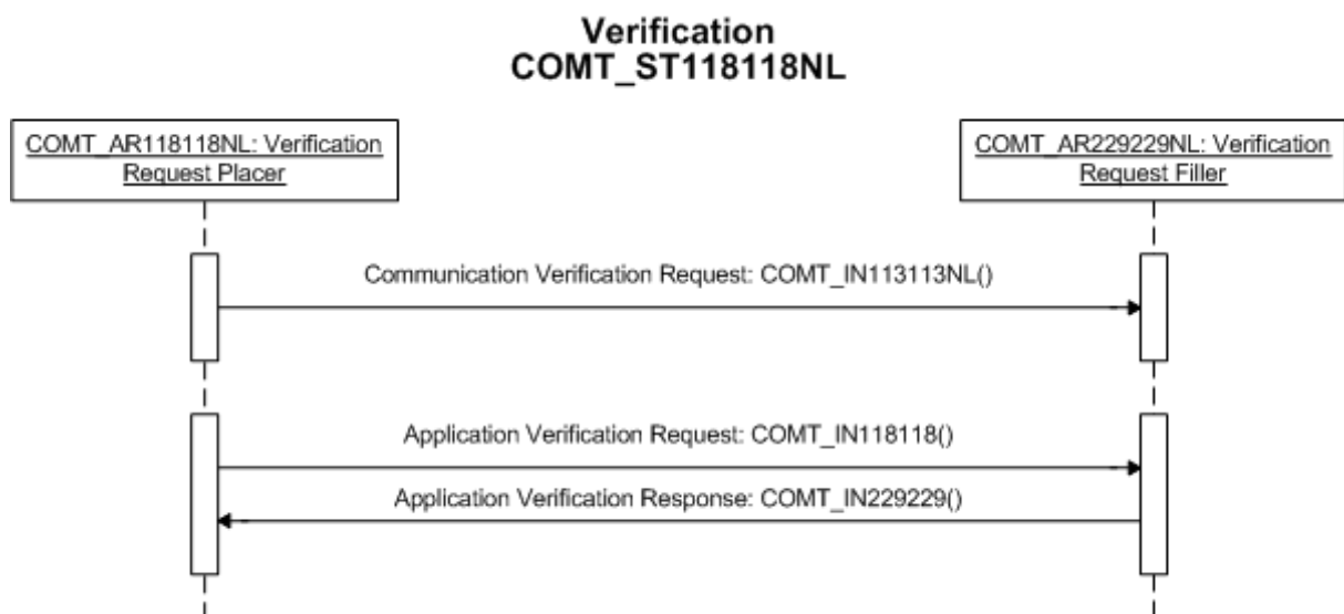
Figuur 1 Interactiediagram Verifiëren communicatiekoppeling / applicatiekoppeling
